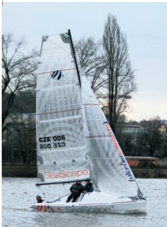
Moderní hlavní plachta se samovypouštěcí čtvercovou hlavou ikosatka jsou ušity ze speciálního laminovaného materiálu.
