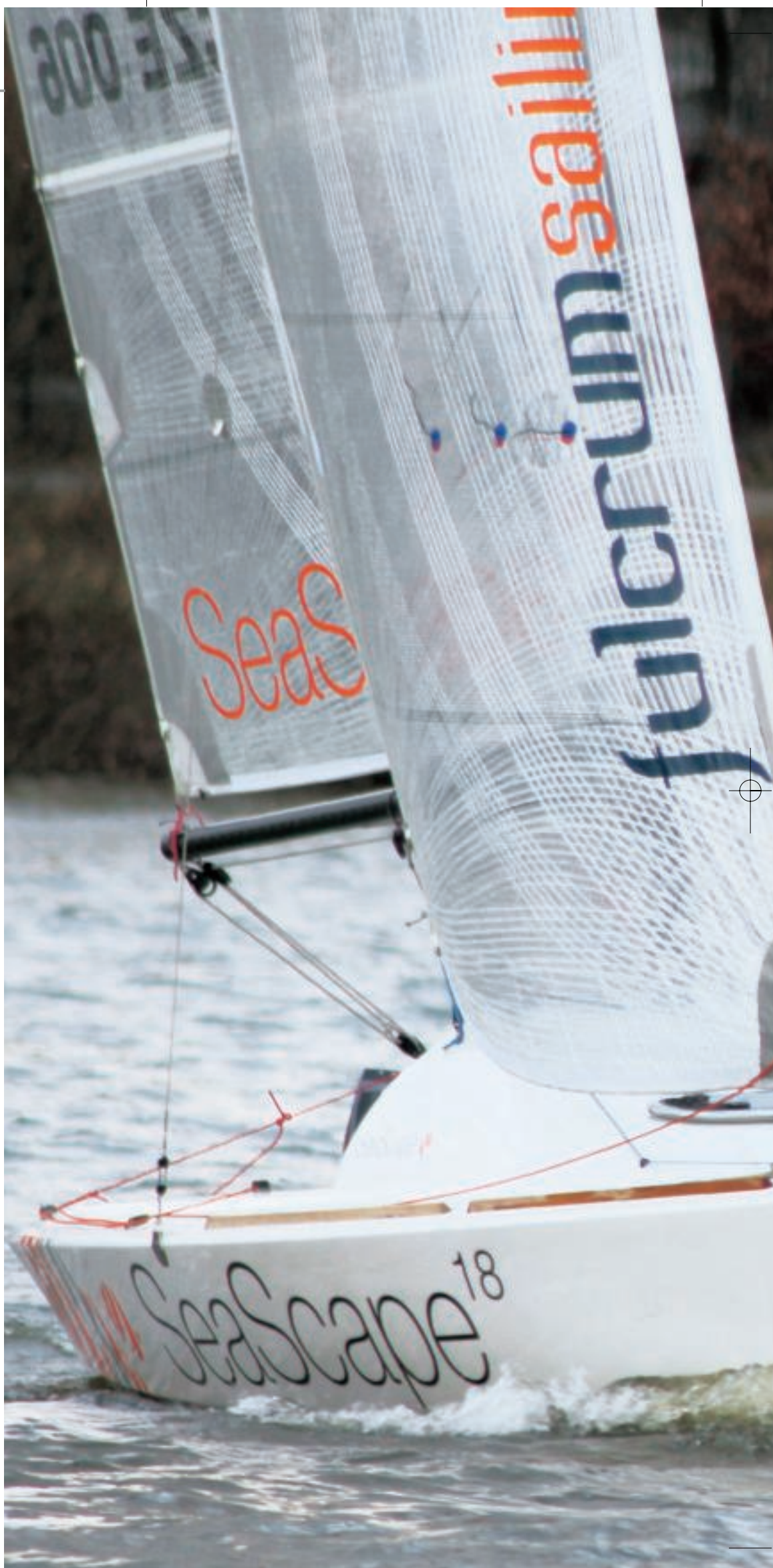
Moderní hlavní plachta se samovypouštěcí čtvercovou hlavou ikosatka jsou ušity ze speciálního laminovaného materiálu.
